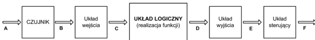
Rysunek 2.6. Przykładowy system z wykorzystaniem układu logicznego
